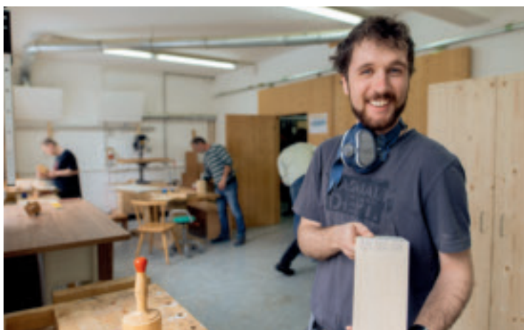
Lukas Schilhan arbeitet gerne in der Tischlerei. Hier präsentiert er eine Holzverbindung aus fein ausgearbeiteten verleimten Zinken.
