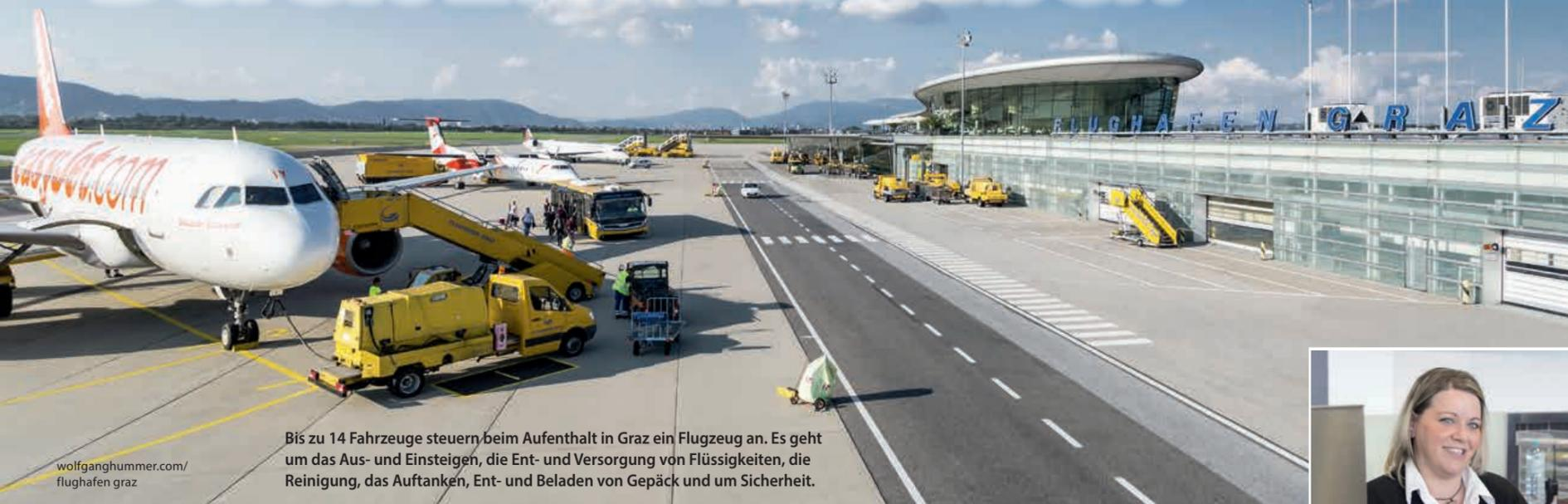
Bis zu 14 Fahrzeuge steuern beim Aufenthalt in Graz ein Flugzeug an. Es geht um das Aus- und Einsteigen, die Ent- und Versorgung von Flüssigkeiten, die Reinigung, das Auftanken, Ent- und Beladen von Gepäck und um Sicherheit.
